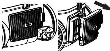
2. Entfernen Sie den Filter hinten am Staubsauger.
